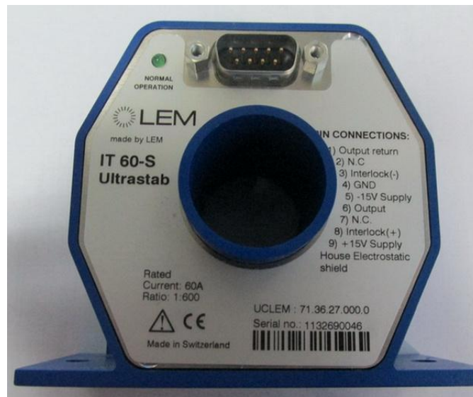
图 3.3 闭口式电流传感器
