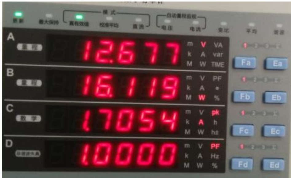
图 4.5 电流钳正接测试结果
