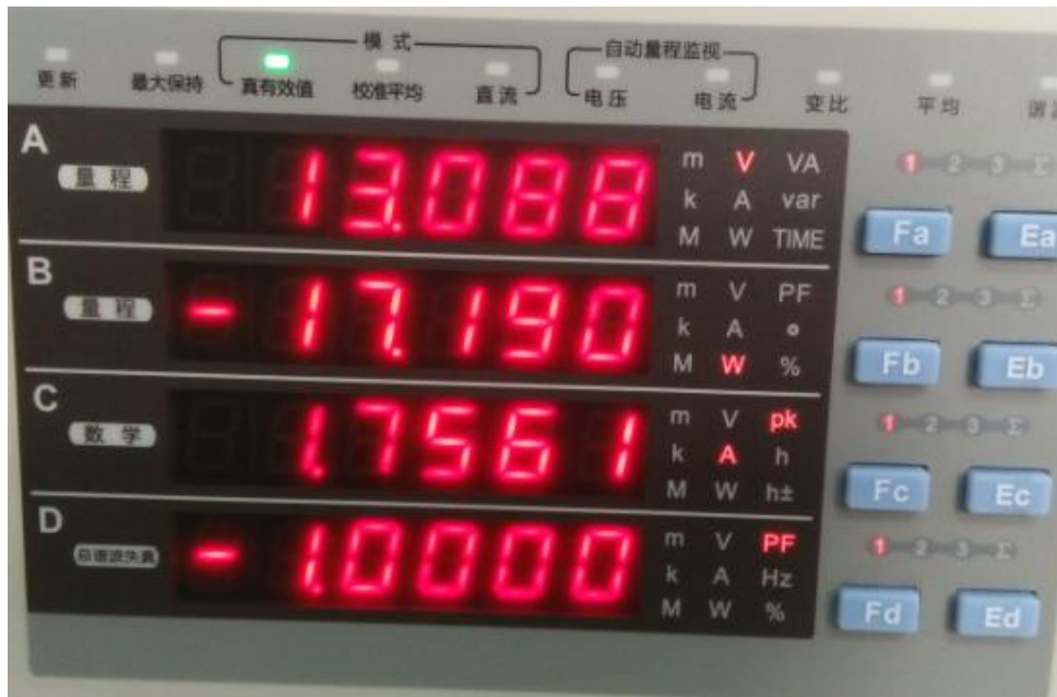
图 4.6 电流钳反接测试结果
