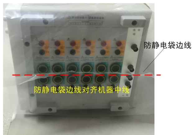
图 3.5 防静电袋边线对齐机器中线
